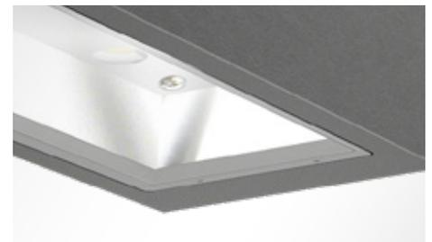
LED-Reflektor aus Reinstaluminium (99,9 %) mit PDV (Physical Vapour Deposition)-Behandlung in 5 Schichten für eine garantierte Gesamtreflexion gegen Korrosion (> 95 %)
