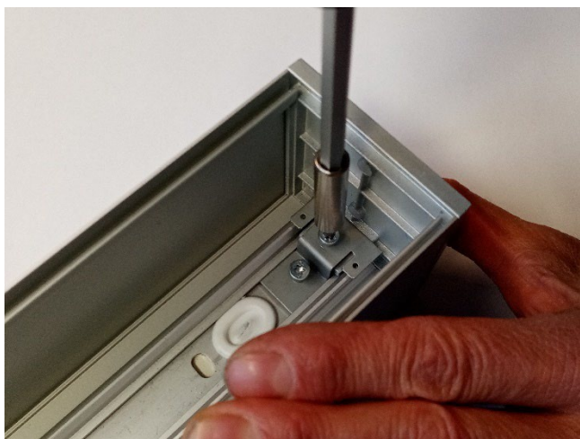
Zweite Schraube bis Ende eindrehen Screw in the second screw to the end
