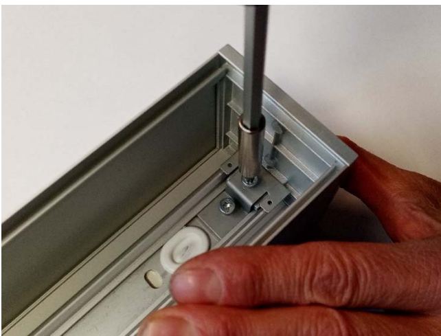
DE: Zweite Schraube bis Ende eindrehen EN: Screw in the second screw to the end FR: Visser la deuxième vis à l'extrémité
