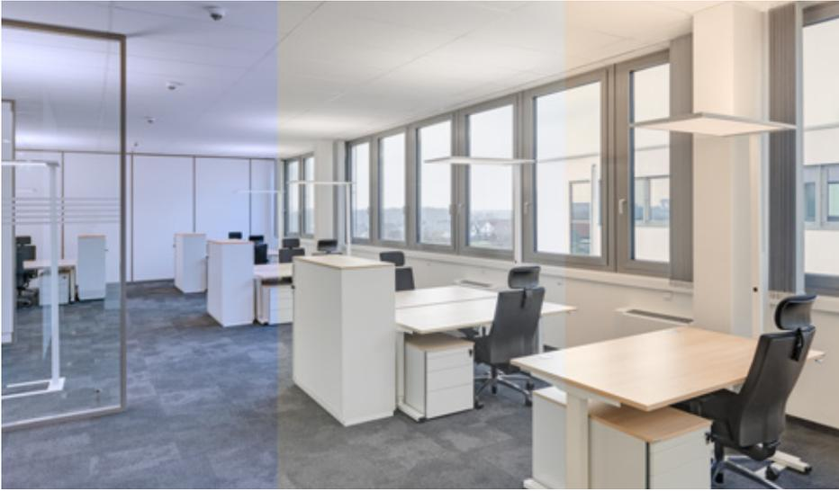
La versión HCL de la parte indirecta imita la evolución dinámica de la luz diurna y varía automáticamente los niveles de iluminancia y el color de luz de 2700 K a 6200 K en función de la hora del día
